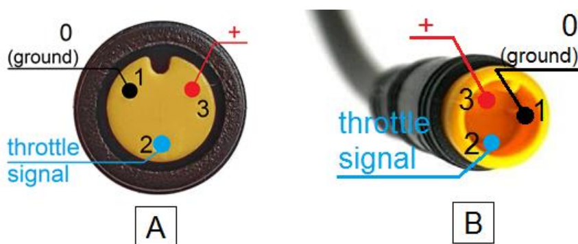
Rys. 5.2 Układ wiązek w okablowaniu fabrycznym manetki; A – gniazdo żeńskie HIGO-B3-B (zakończenie przewodu manetki), B – wtyczka męska HIGO-S3-B (oczekiwane wyjście ze sterownika)
