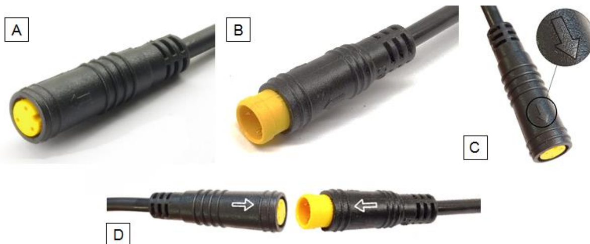
Rys. 5.1 Połączenie gniazda i wtyczki 3-żyłowej HIGO; A – gniazdo żeńskie HIGO-B3-B, B – wtyk męski HIGO-S3-B, C – oznaczenie ułatwiające wzajemne zorientowanie łączonych elementów , D – prawidłowa orientacja łączonych elementów
